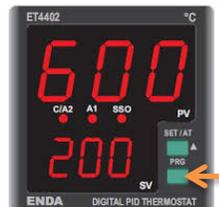
Um das Einstellmenü zu verlassen und in die Betriebsposition zurückzukehren, drücken und halten Sie die Taste (B) für 3 Sekunden oder warten Sie 10 Sekunden ohne eine Taste zu drücken.
